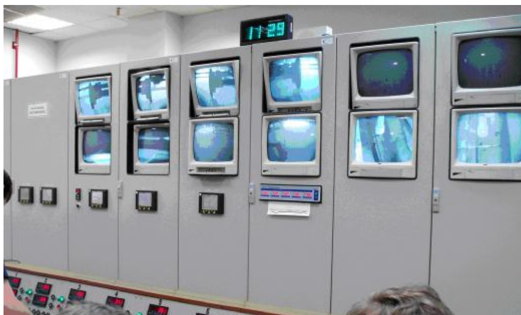
Рис.3 5- канальный цифровой индикатор устанавливается в операторной на пульте управления ванной расплава. На индикаторе отображается толщина по всем 5 каналам с разрешением 0,01 мм (результаты с разрешением 0,001 мм выводятся графически на промышленный компьютер).
