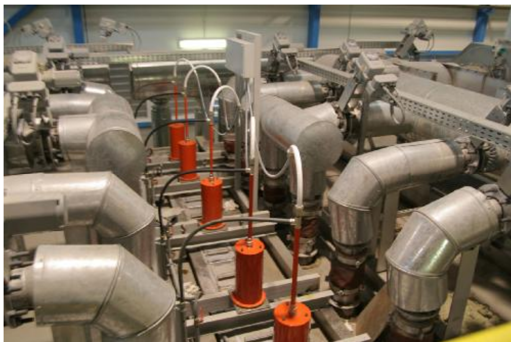
Рис. 5. Оптические головки, установленные между зонами А и В печи отжига
