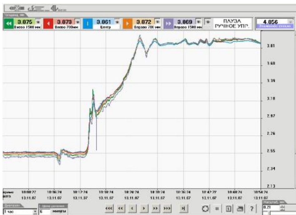
Рис.8 Типичный график перехода с толщины 2,5 мм на толщину 4 мм при использовании Системы. Время перехода составляет около 15 минут.
